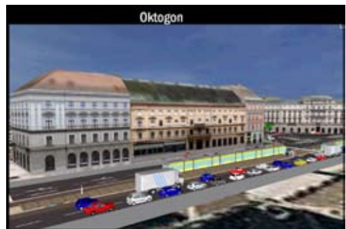
Budapest egyik részhálózatának számítógépes (Vissim) forgalmi modellje
